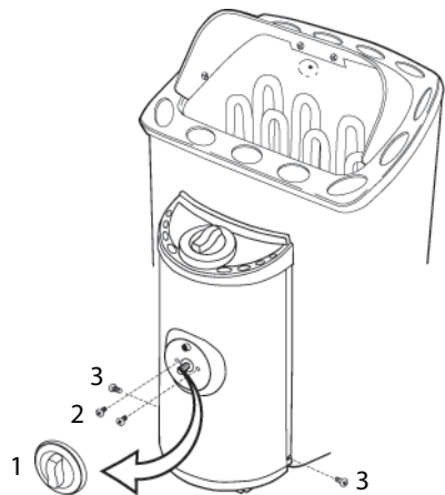
Kuva 3A Ohjausyksikön avaaminen Fig. 3A Opening of the Control Unit
